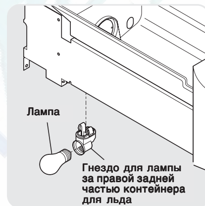
Замена лампы морозильника
